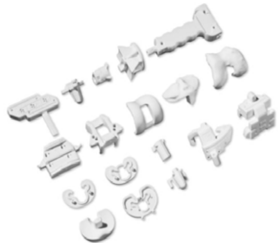
Abb.3: Anhand der computerbasierten Planung wird ein einzigartiger Instrumentensatz mit 3D-Druckern hergestellt. Der Einmalgebrauch wird höchsten Hygieneansprüchen gerecht.
